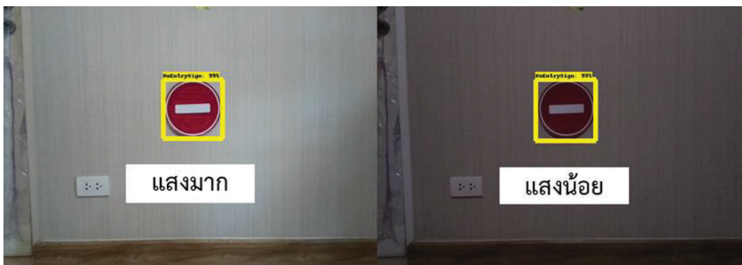
รูปที่ 11: รูปภาพป้ายจราจรจากสภาพแวดล้อมในที่แสงมาก (ซ้าย) และในที่แสงน้อย (ขวา)
